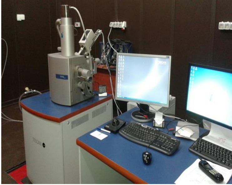
الشكل (5) يبين المجهر الالكتروني الماسح VEGA II XMU
