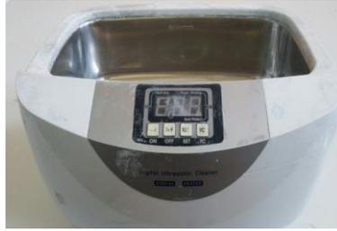
الشكل 4 : شكل توضيحي لجهاز الأمواج فوق الصوتية
