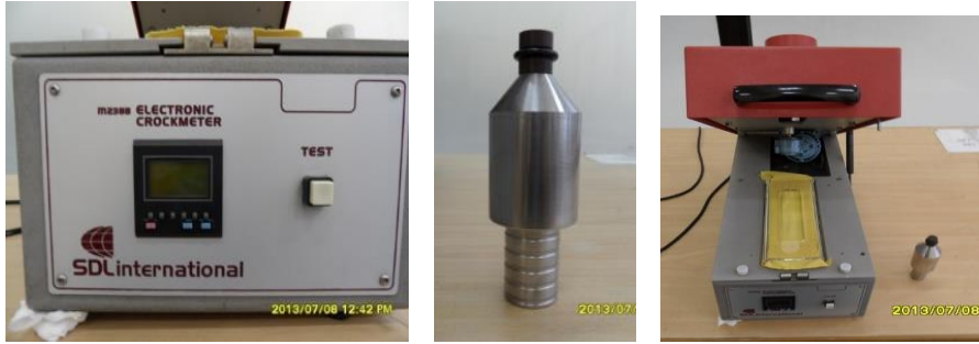
الشكل (2): جهاز اختبار الثباتية للاحتكاك المستخدم ورأس الحكّ ولوحة التحكم الخاصة به.
