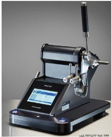
الشكل (4) جهاز اختبار قوة التمزق
