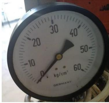
الشكل (8) يبين مقياس الضغط الذي يقيس ضغط الزيت في المكبس.
