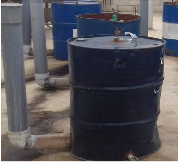
الشكل [1] صورة للمخمر الذي تم تصميمه من الطراز الصيني D1
