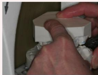
وضع المثالين على المُشَدِّبة الكهربائية وبينهما العضة الشمعية
