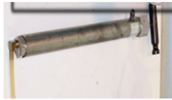
شكل ( ١ -٨) مضخة شحن الزيت اليدوية
