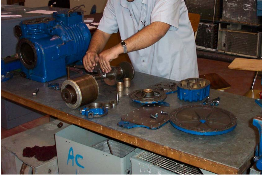
شكل (٨ - ١١) مراجعة حالة أجزاء الضاغط
