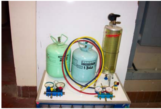
شكل ( ١ -٧) مجموعة الشحن ووحدة استعادة وسيط التبريد
