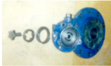
شكل (٨ - ٣) مضخة الزيت ومكوناتها وكروسي التحميل من جهتها
