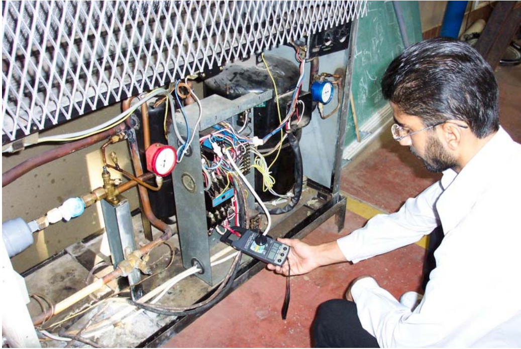
شكل (٢- ٤) إجراء الصيانة للوحدات المجمعة
