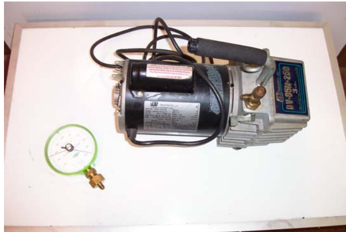
شكل (١- ٦) بعض مجموعة التفريغ وإزالة الرطوبة
